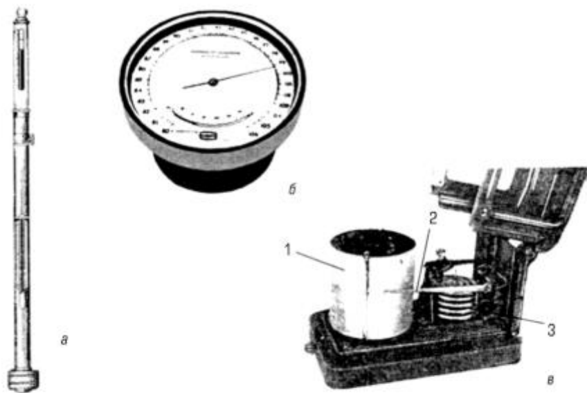
Рис. 9.3. Приборы для измерения атмосферного давления: а — ртутный чашечный барометр СР-А; б — барометр-анероид БАММ-1; в — барограф М-22А: 1 — барабан с лентой; 2 — стрелка с пером; 3 — анероидные коробки
