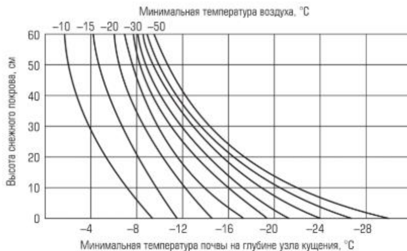
Рис. 7.6. Связь минимальной температуры почвы на глубине 3 см с минимальной температурой воздуха при различной высоте снежного покрова (по А.М. Шульгину)
